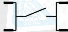
(с) Обозначение на схемах с двумя парами контактов
