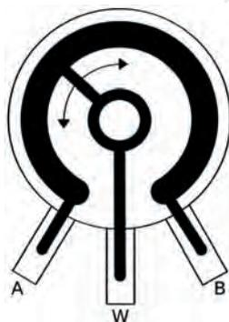
Рис. 12.4: Устройство потенциометра
