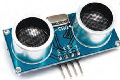
Рис. 13.1: Ультразвуковой датчик HC-SR04
