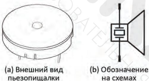
Рис. 5.1: Пьезоэлемент
